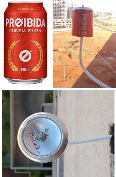
Imagem: Antena com lata de cerveja de Thiago Pereira Machado. A receita é basicamente 1 conector F fêmea conectado a uma extremidade de um cabo coaxial (TV) de 50 ohms, um fundo de lata de cerveja de 269 ml ( a famosa latinha piriguete), com uma "parede" de 7 cm e um cabo coaxial de 7 cm acima do fundo da lata , que vai para o conector fêmea. Ele não utilizou medições extremamente precisas, nem amplificadores, filtros, etc.
