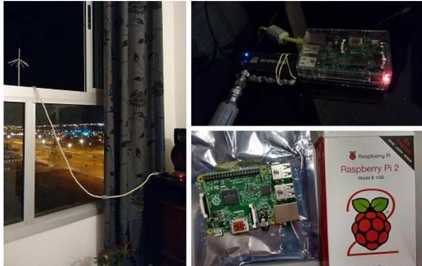
Imagem: Equipamento do Thiago, receptor RTL-SDR com Raspberry Pi 2 para receber mensagens do Modo S e ADSB na frequência de 1090 MHz.
